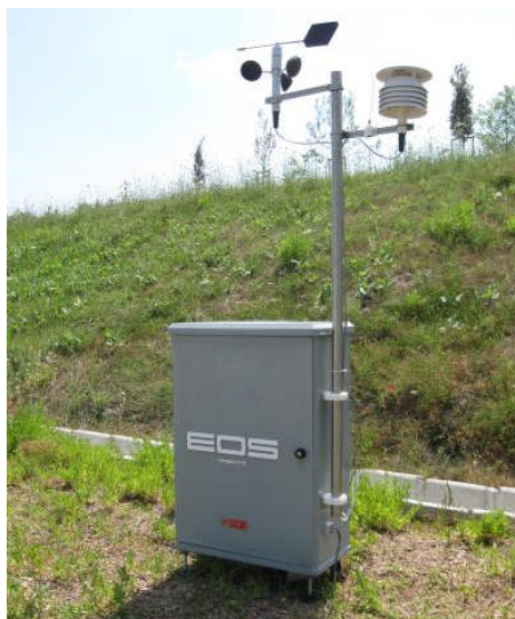
Figura 1. Un EOS Ambiente SACMI installato al perimetro di un impianto.
